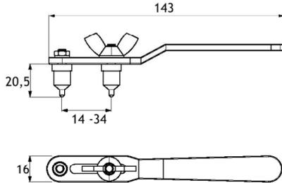
Chiave regolabile per il serraggio delle borchie a due punti
